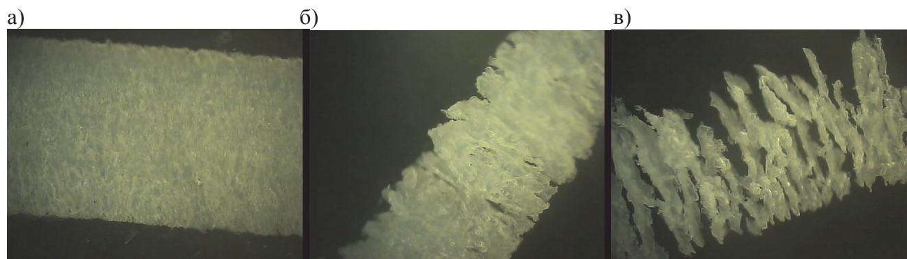
Рис. 3. Фотографии стружек при обработке фторопласта: а – скорость резания 100 м/мин; б – скорость резания 150 м/мин; в – скорость резания 200 м/мин
