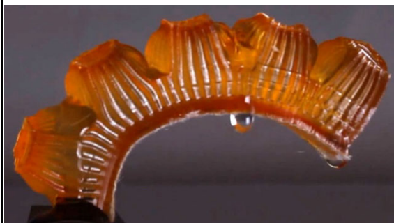
Рис. 10. Элемент схвата, обладающий способностью терморегуляции
