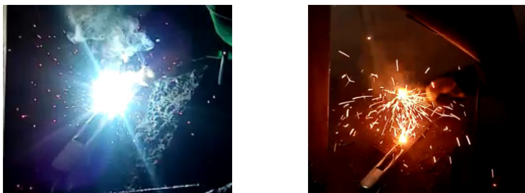
Рис. 3. Мелкодисперсное разбрызгивание при сварке
