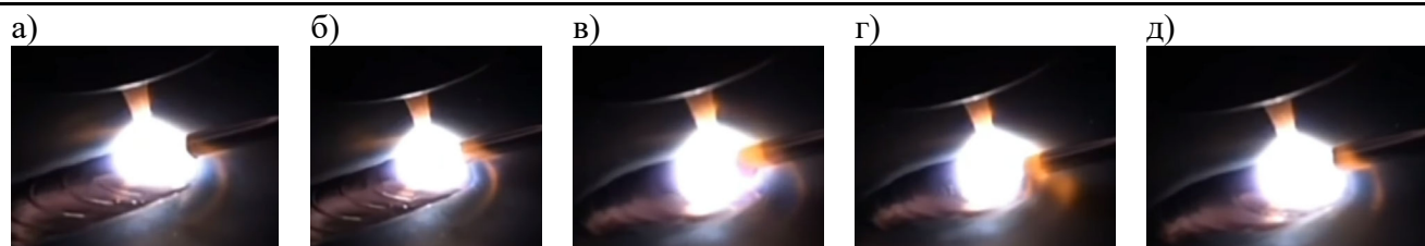
Рис. 6. Последовательность выполнения шва по методу «Капля в ванну»:
