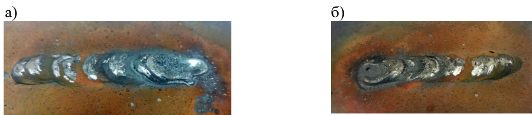
Рис. 2. Наплавленные валики на режиме 80 А на постоянном токе: а – прямая полярность; б – обратная полярность
