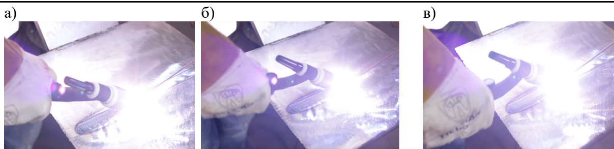
Рис. 3. Манипуляция положением горелки: а – крайнее левое; б – среднее; в – крайнее правое
