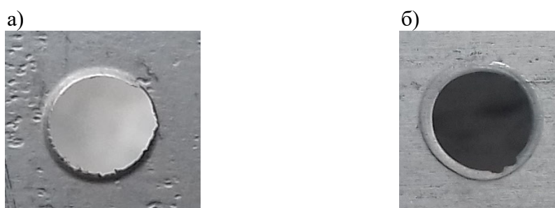
Рис. 3. Заусенец, образовавшийся по окружности отверстия в слое из титанового сплава (а) и алюминиевого сплава (б)
