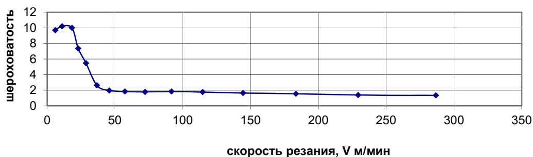
Рис. 9. Зависимость шероховатости R_a от скорости резания для стали У8. S = 0,11 мм/об.
