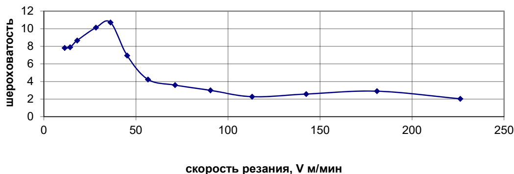
Рис. 8. Зависимость R_a шероховатости от скорости резания для стали 45. S = 0,11 мм/об.
