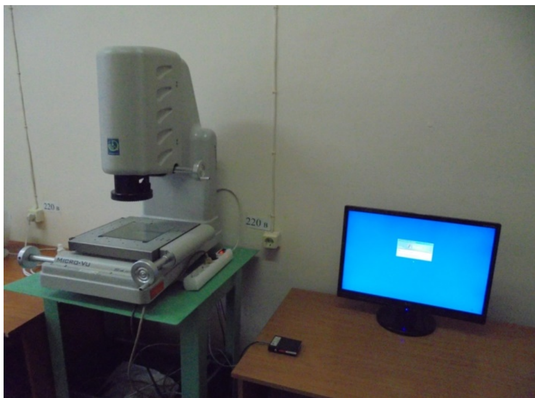
Рис. 3. Внешний вид мультисенсорного измерительного центра модели Mikro Vu Sol 161
