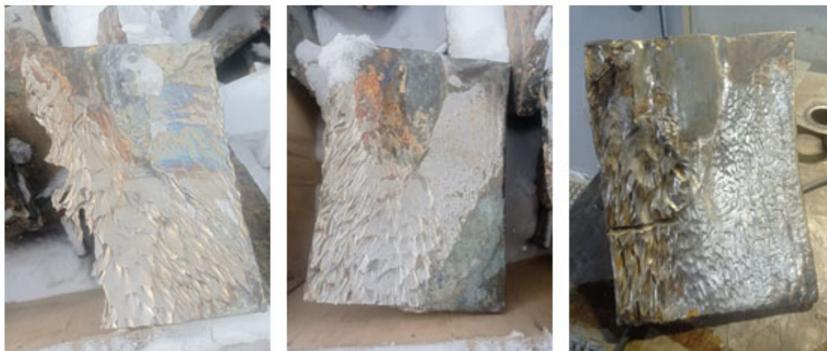
Рис. 2. Аварийный износ лопаток импеллера мешалки
