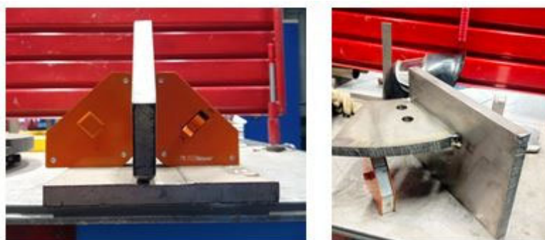
Рис. 5. Сборка деталей на прихватки и установка в положение под сварку
