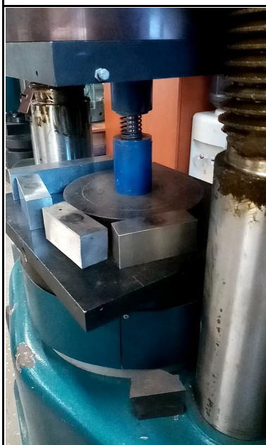
Рис. 1. Внешний вид оснастки для прессования
