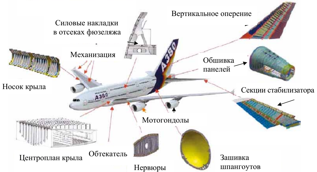
Рис.1. Поверхности планера самолета, элементы которых выполнены из композиционных полимерных материалов
