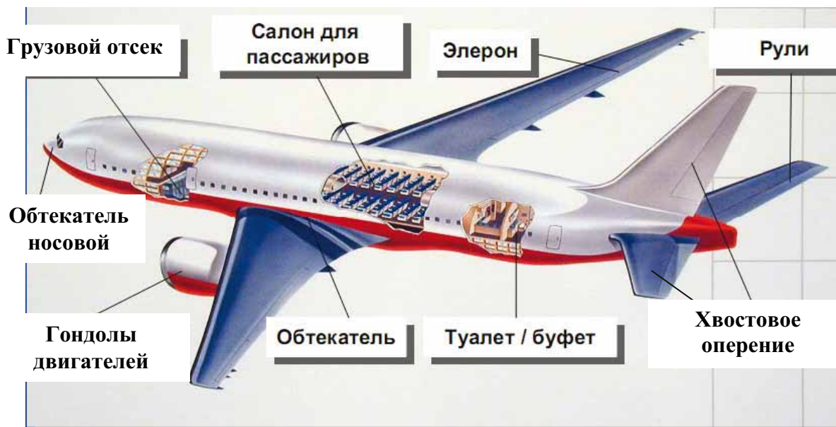
Рис. 2. Внешние и внутренние поверхности планера самолета, в которых использованы лакокрасочные покрытия
