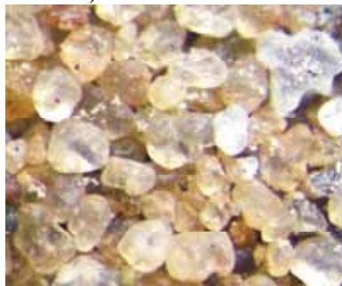
Рис. 2. Структура смеси песка с MgSO_4 \cdot 7H_2O (5 масс. ч.) после сушки (увеличение 20^{\times} )
