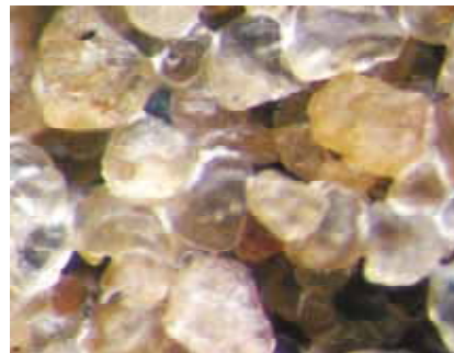
Рис. 3 Структура смеси песка с MgSO_4 \cdot 7H_2O (5 масс. ч.) и воды (5 масс. ч.) после сушки (увеличение 25^{\times} )
