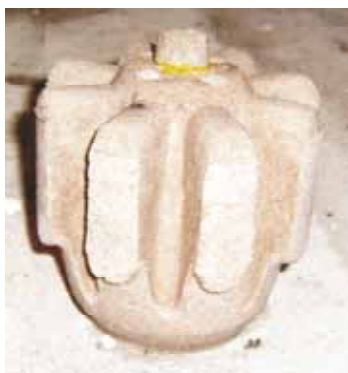
Рис. 6. Стержень, изготовленный из смеси с соевым связующим на основе MgSO_4
