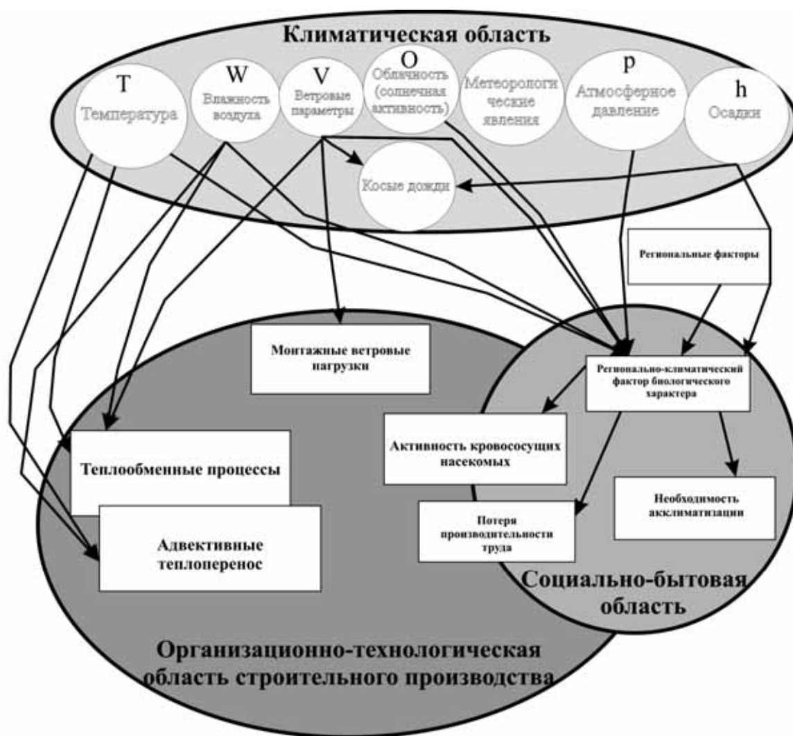
Рис. 2. Организационно-технологическая система строительного производства с комплексным учётом климатического фактора
