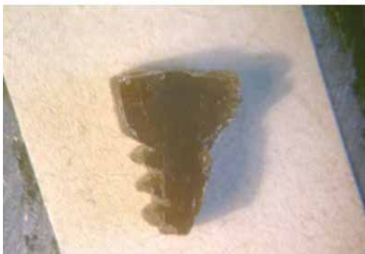
Рис. 4. Модели, полученные прессованием порошкообразного модельного состава с предварительным вакуумированием
