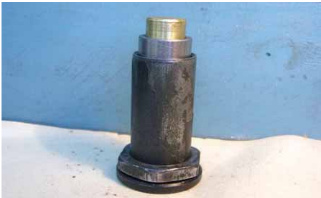
Рис. 2. Пресс-форма для изготовления пористой удаляемой моде-
