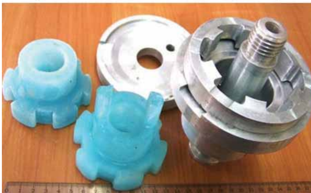
Рис. 3. Пресс-формы для получения ледяных моделей
