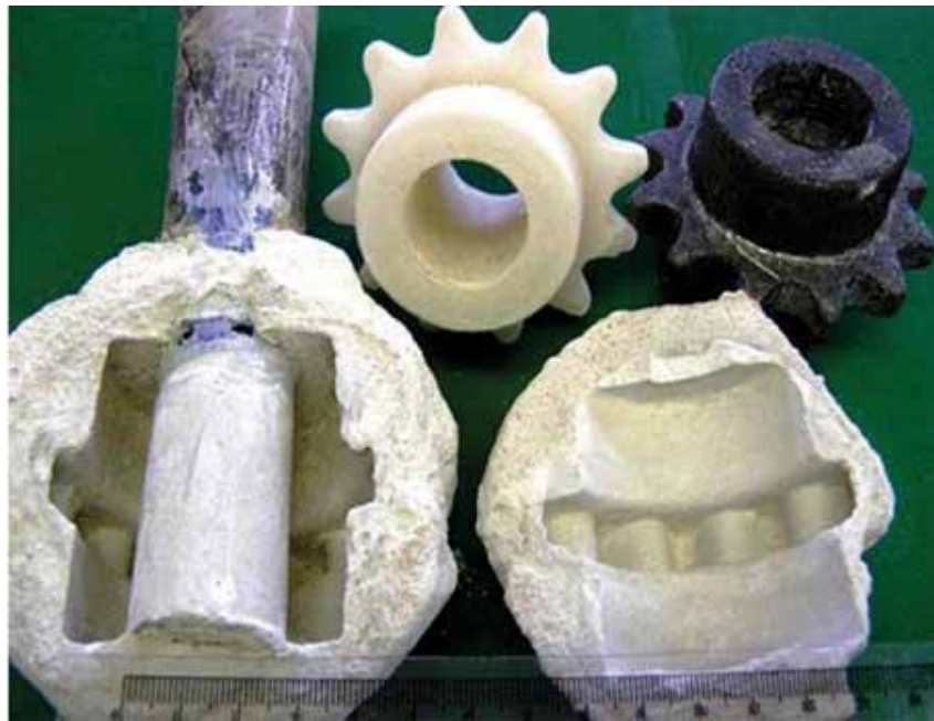
Рис. 2. Оболочковые формы, полученные по ледяным моделям
