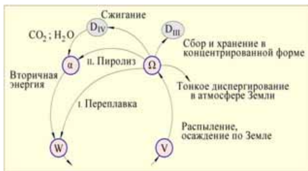
Рис. 7. Стадии ЦКВМ (а) по [17; 18; 21] и схема замкнутого цикла производства и использования вещества и материалов (б) [3]
