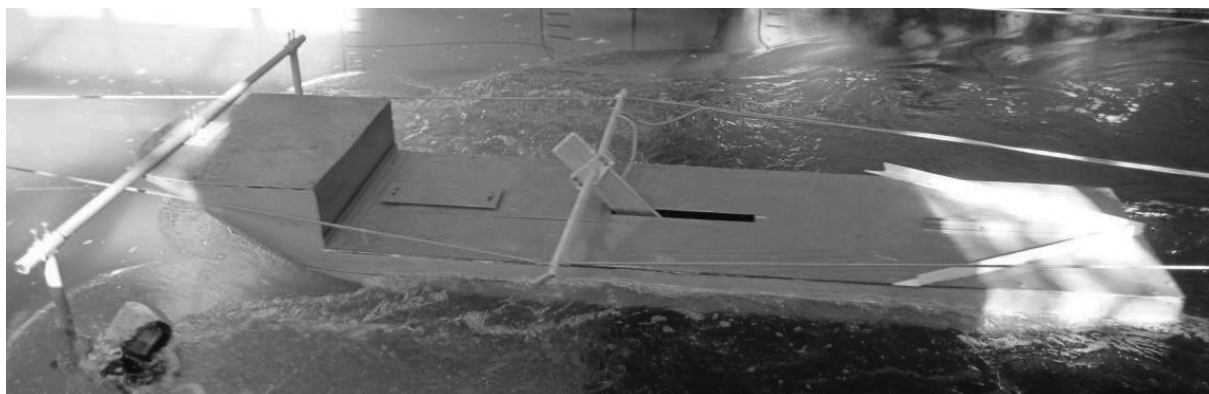
Рис. 9. Модель наплавного судна во время буксировочных испытаний на ГБС
