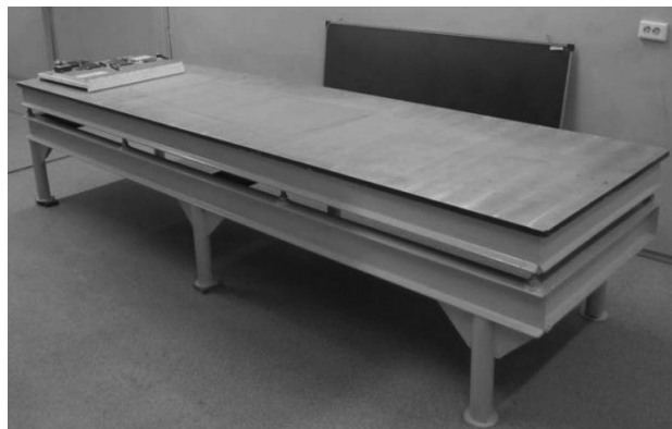
Рис. 6. Прецизионный стапельный стол для сборки и обмера моделей (размер 1000×3500 мм)
