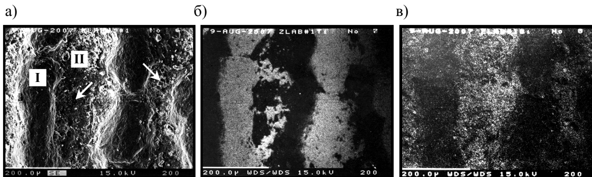
Рис. 9. Распределение элементов на изношенной поверхности комбинированного покрытия (ЦЛАБ-2)/(ВТ1-0) во вторичных электронах (а) и в характеристическом излучении: б – TiK_{\alpha} ; в – OK_{\alpha} (стрелки указывают на дефекты износа)
