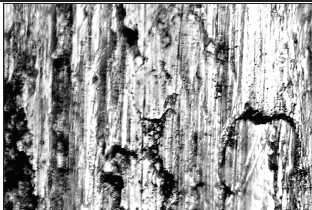
Рис. 5. «Наползание» фрагментированного слоя на поверхности трения медного диска ( \times 100 )
