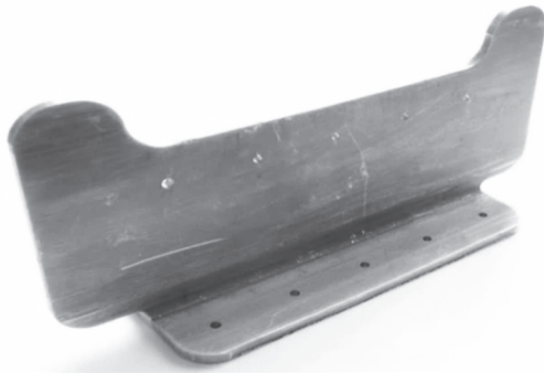
Рис. 11. Деталь, полученная из заготовки, изготовленной по результатам моделирования по схеме 4 разворачивания профиля
