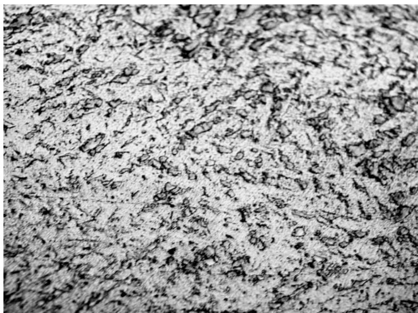
Рис. 7. Микроструктура наплавленного металла ( \times 160 )
