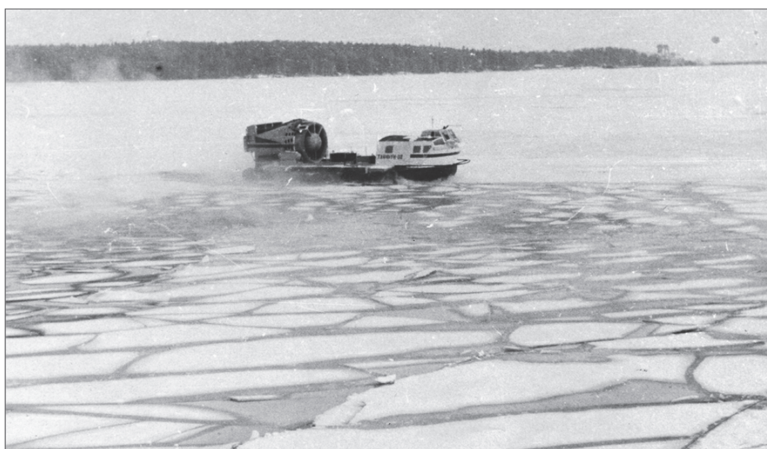
Рис. 2. Характер разрушения ледяного покрова СВП
