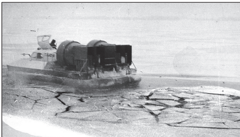
Рис. 5. Характер разрушения ледяного покрова при избыточной энергии ИГВ
