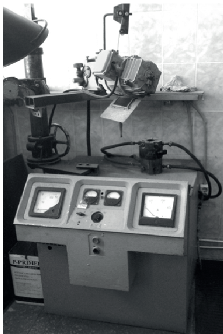
Рис. 6. Установка для электрошлакового переплава
