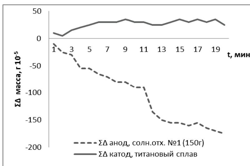
Рис. 17. Кинетика суммарного изменения массы анода (отходы Солнечной ЦОФ № 1 (150 г)) и катода (титановый сплав)
