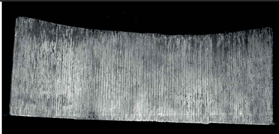
Рис. 2. Отливка, кристаллизовавшаяся без воздействия постоянного электрического тока
