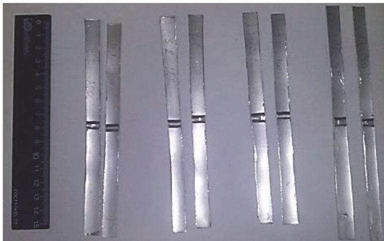
Рис. 2. Образцы, подготовленные к испытанию на статическое растяжение
