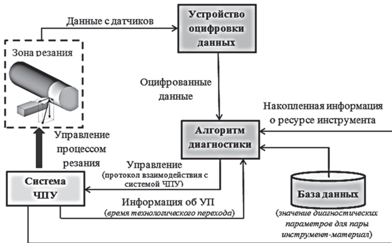
Рис. 2. Модель диагностирования и прогнозирования состояния режущего инструмента на станках с ЧПУ
