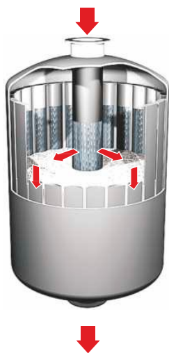
Рис. 3. Распределение газосырьевой смеси по реактору
