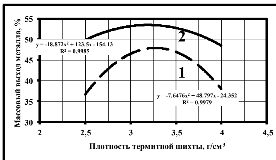
Рис. 6. Зависимости массового выхода восстановленного металла от плотности упаковки термитных смесей уплотненных: 1 – без обработки в шаровой мельнице; 2 – после обработки в шаровой мельнице
