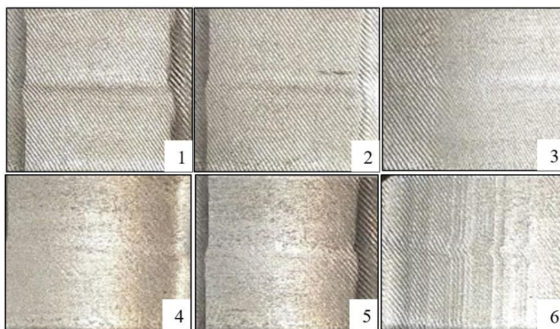
Рис. 10. Вид обработанных поверхностей при концевом фрезеровании с глубиной модуляции: 1 – A=0 %; 2 – A=1 %; 3 – A=2 %; 4 – A=3 %; 5 – A=4 %; 6 – A=5 %
