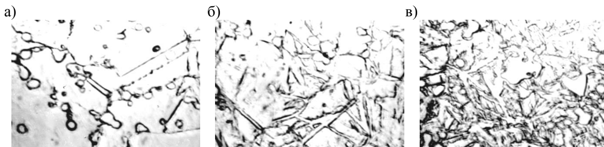
Рис. 3. Влияние времени выдержки между закалкой и обработкой холодом на количество остаточного аустенита в стали 95X18Ш. Режим аустенизации – 1200 °С в течение 30 мин, увеличение – в 1440 раз: а – без обработки холодом; б – обработка холодом проведена сразу после закалки; в – обработка холодом проведена через 2 ч после закалки
