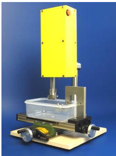
Рис. 5. Настольный прецизионный электроэрозионный копировально-прошивочный комплекс ДГТ-ЭП-03
