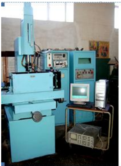
Рис. 3. Копировально-прошивочный электродный станок (а) и схема экспериментальной установки (б): 1 – электрод-инструмент; 2 – электрод-заготовка; 3 – рабочая жидкость; 4 – генератор; 5 – канал заряда; 6 – лунка, образованная разрядом; 7 – газовый пузырь; 8 – частицы металла (шлам); 9 – продукты пиролиза
