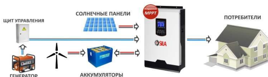
Рис. 2. Схема комбинированной установки для использования в домах с круглогодичным проживанием
