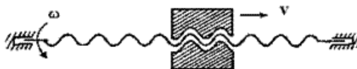
Рис. 3. Кинематическая схема передачи винт-гайка
