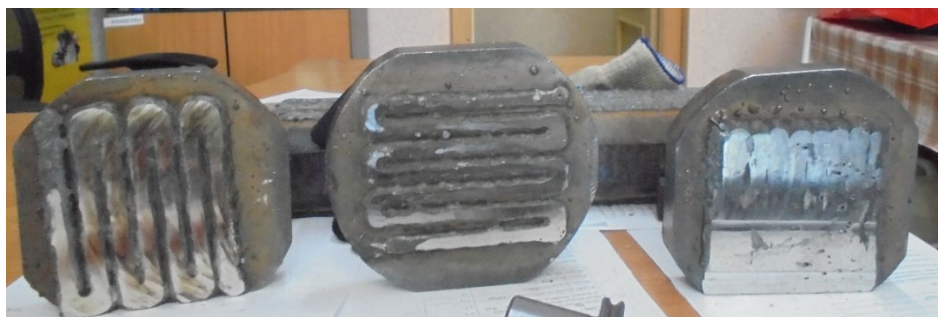
Рис. 2. Примеры обработанных поверхностей, на которые наплавками были нанесены высокотвёрдые (HRC 65) слои разных параметров (левый образец – высота наплавки равна двум ширинам наплавки, в центре – высота наплавки равна ширине наплавки, справа – сплошная наплавка)
