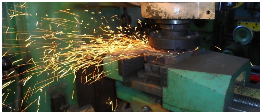
Рис. 1. Пример отработки рациональных параметров режима резания фрезерование на форсированной скорости резания
