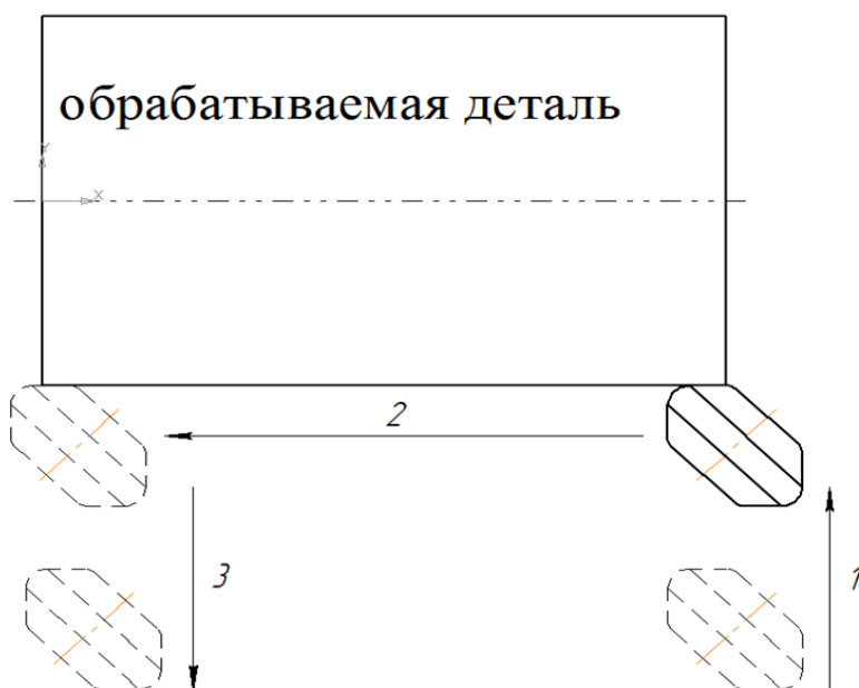
Рис. 2. Маршрут движения ролика при обработке детали
