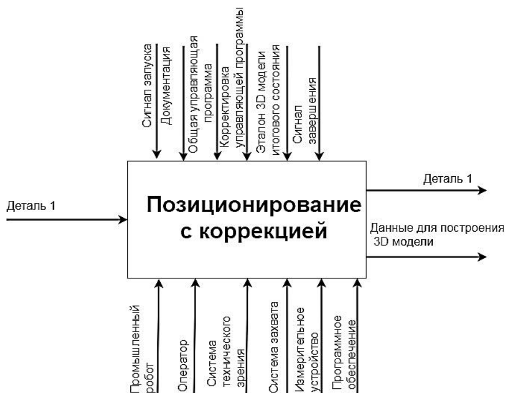
Рис. 3. Функциональная декомпозиция технологической операции «Позиционирование» в рамках технологического процесса роботизированной сварки
