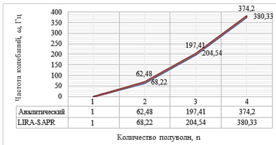
Рис. 2. Зависимость частоты колебания от количества полуволн оболочки из бетона класса В20
