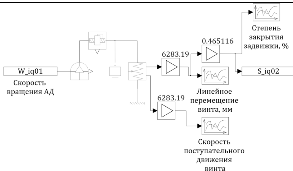
Рис. 3. Модель механизма винт-гайка электромеханической системы
