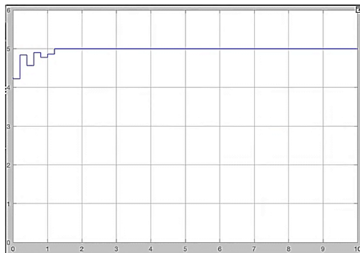
Рис. 4. Скачок напряжения на ёмкости при её уменьшении
