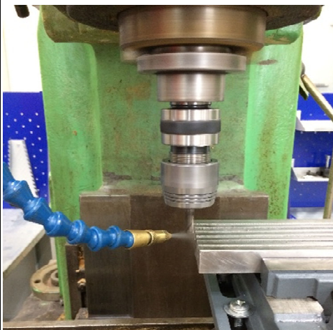
Рис. 3. Подача СОТС в зону резания
