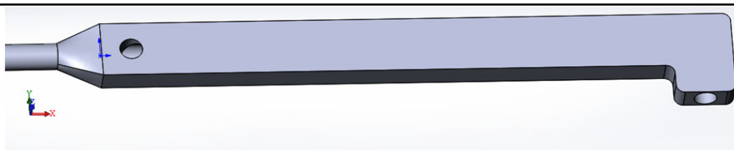
Рис. 6. Лопасть с длиной «колена», равной 0,05L , лопасть загнута под углом 90^\circ
